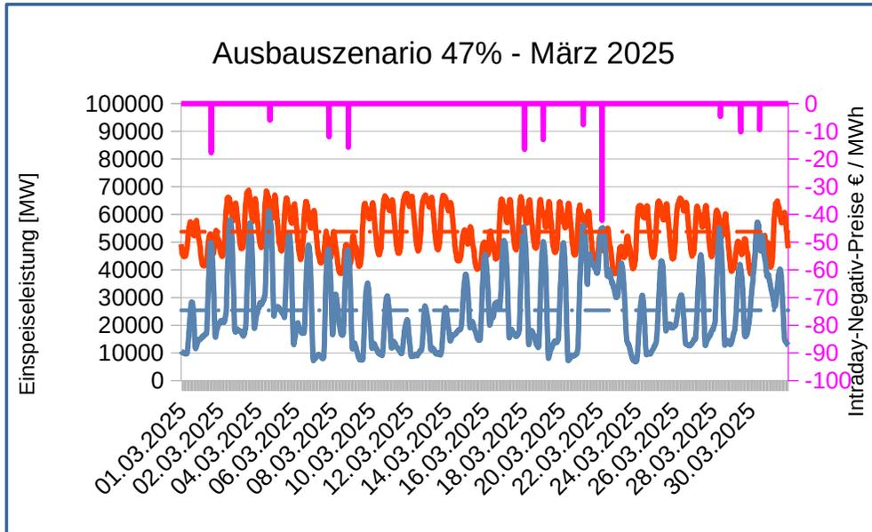
**Diagramm 1:** Verläufe von Ökostromerzeugung (Wind, PV, Biomasse und Wasserkraft) und Stromverbrauch bei aktuellem Ausbaustatus März 2025. Ca. 20 Erzeugungsspitzen im Monatsverlauf erreichen schon im aktuellen Ausbaustatus kurzzeitig den Streubereich des Bedarfs (entspr. 100% EE-Anteil). Es treten 11 Negativpreise auf (violette Darstellung).
