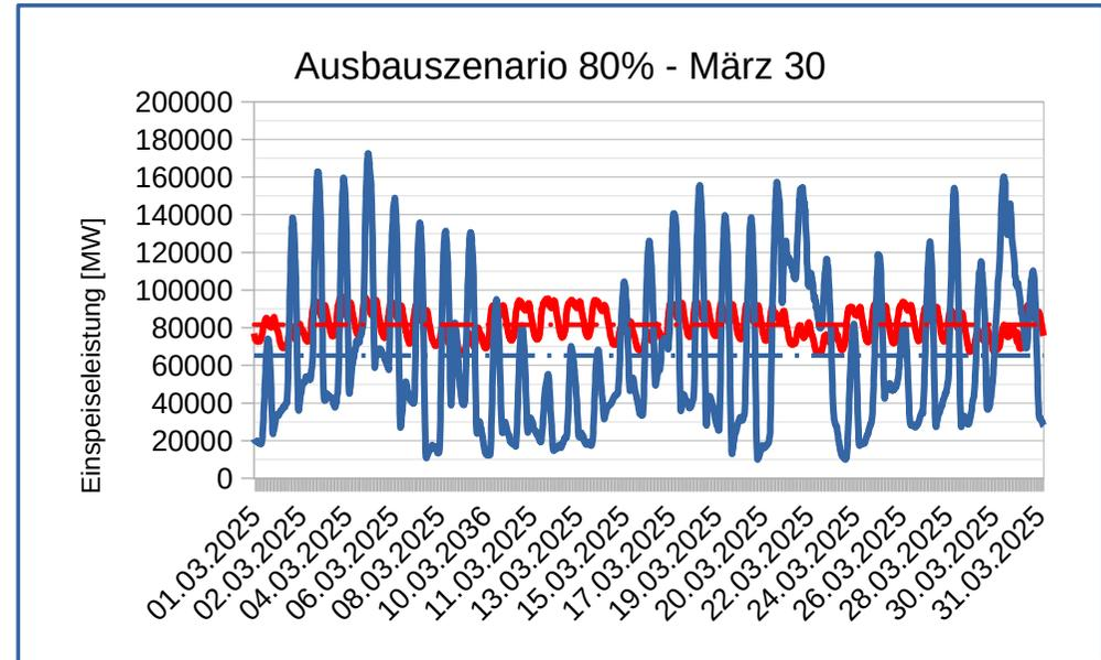
**Diagramm 2:** Verläufe von Ökostromerzeugung (Wind, PV, Biomasse und Wasserkraft), hochgerechnet aus März 2025 entspr. Planungsziel BMWK für März 2030
