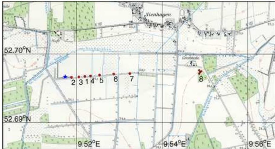
Infraschallmessung an 200 kW Windkraftanlage vom Typ Vestas V47 nördlich von Hannover. Die Registrierung mit MB2000 Mikrobarometern erfolgte entlang eines etwa 2 km langen Profils
